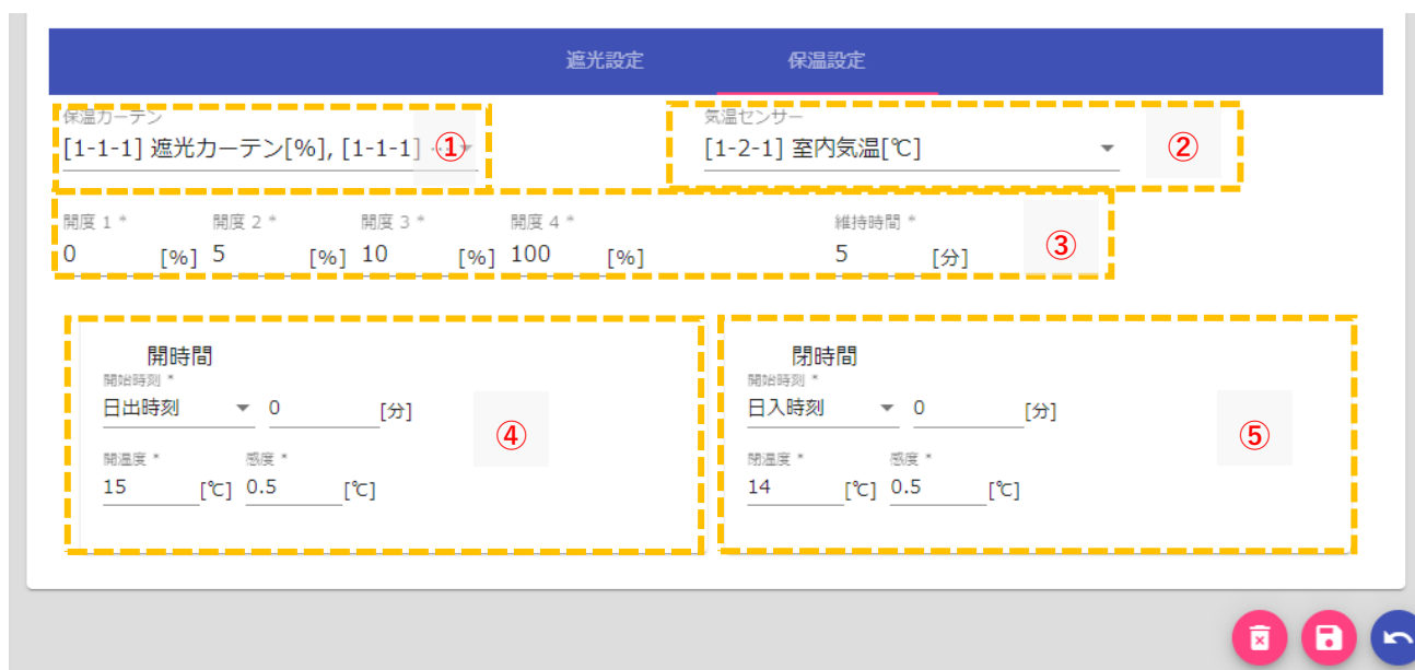
図 4：カーテン制御（保温設定）画面
