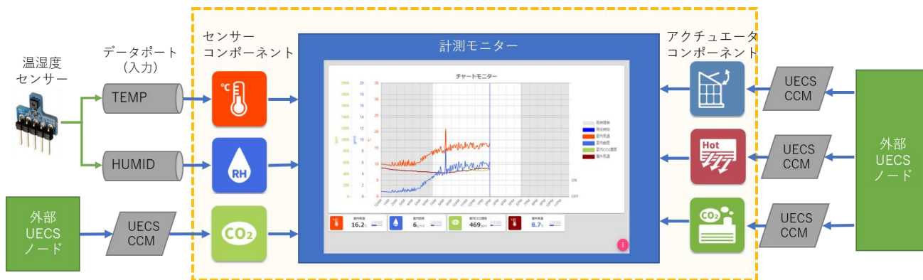
図 20：計測モニター機能関連図
