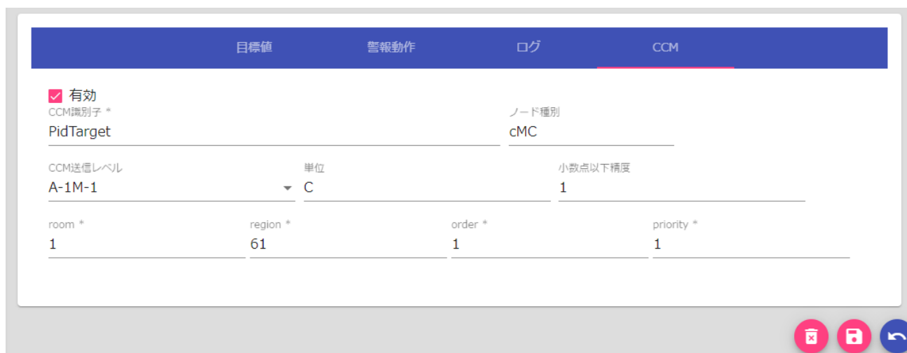
図 38 : PID 目標値 CCM 設定画面
