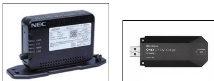
図 60：インターネット接続機器例（左：耐熱ルータ / 右：USB-LTE 端末）
