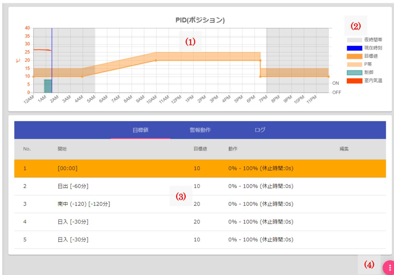
図 32 : PID 制御モニター画面
