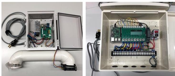
**図 2 : Arsprout DIY キット(計測・制御)**
