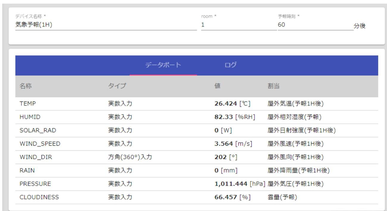
図 53：デバイス設定（簡易外気象センサー）画面
