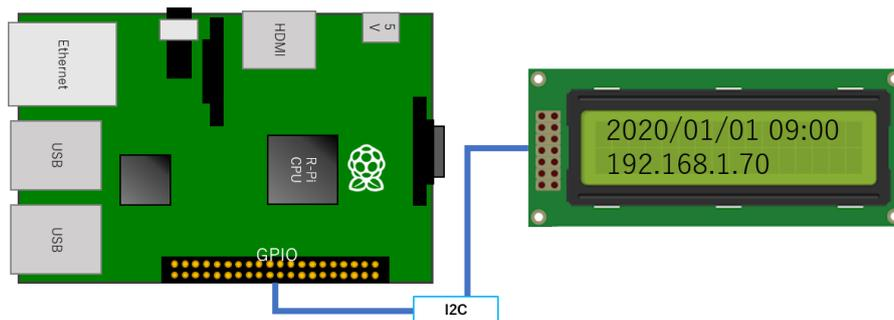
図 58 : LCD デバイス接続模式図
