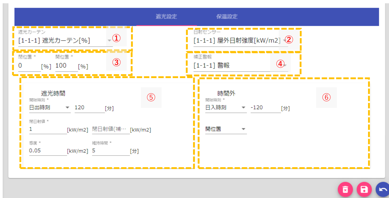
図 3 : カーテン制御 (遮光設定) 画面
