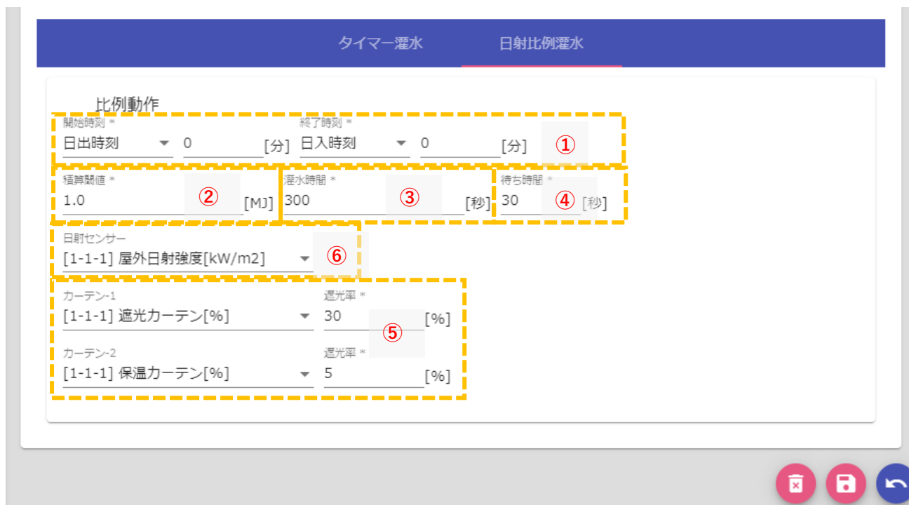
図 6：日射比例灌水設定画面
