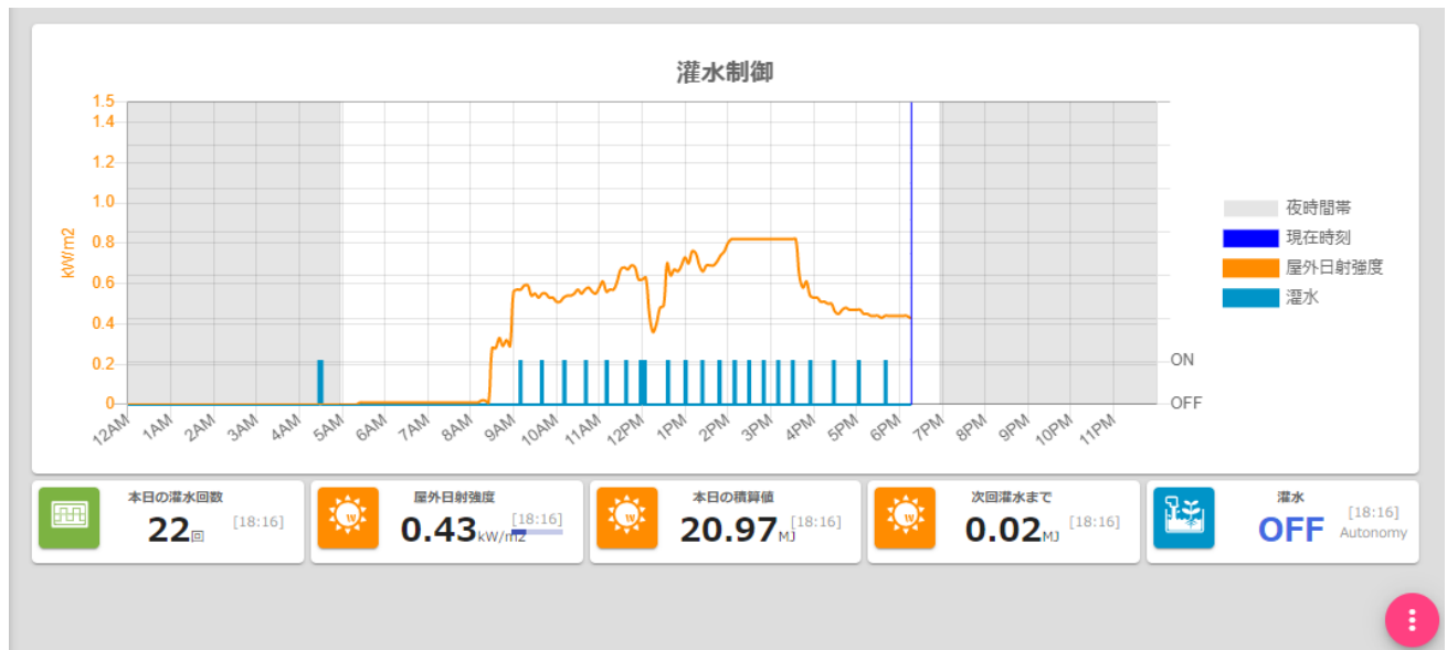
図 5：灌水制御ダッシュボード画面
