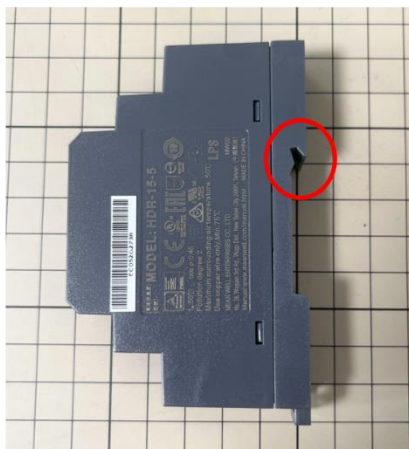
爪部分をDINレールに引っ掛けるようにセット
