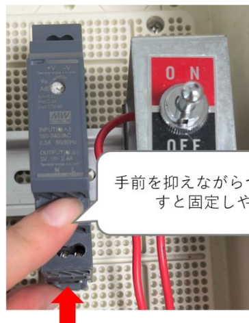
つまみを戻してDINレールに固定
