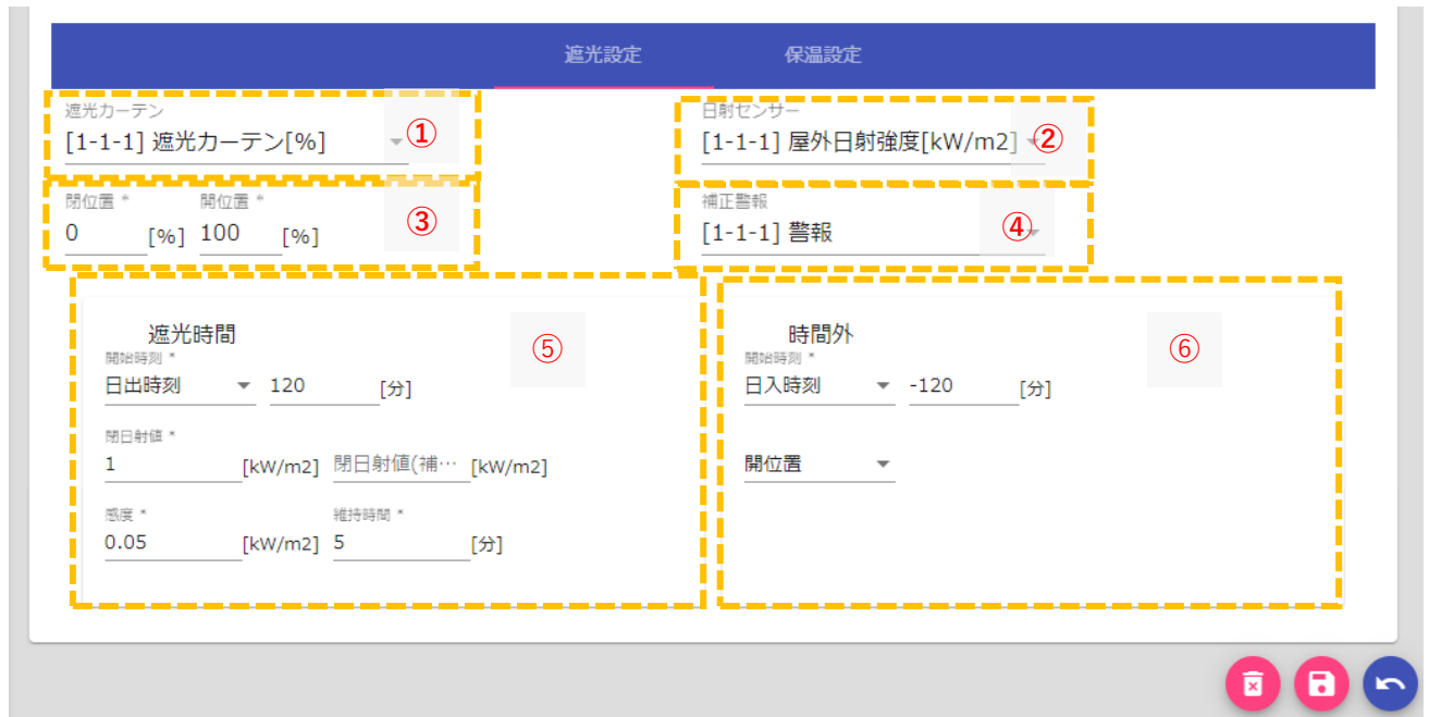
図 3 : カーテン制御 (遮光設定) 画面
