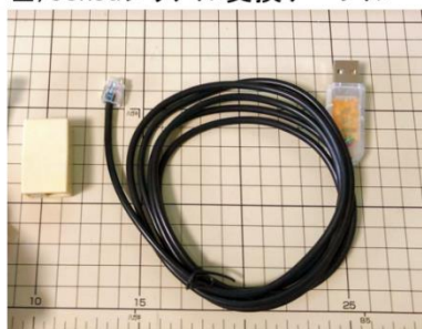
右) RJ11メスメスコネクタ 左) SenSuシリアル変換ケーブル
