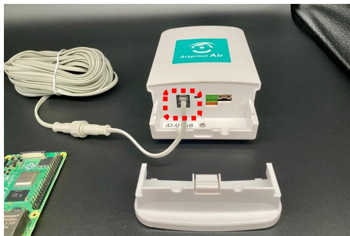
図 5 : Air ノード（親機）通信ケーブル接続
