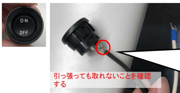
波動スイッチ 波動スイッチと電源ケーブルをはんだ付け
