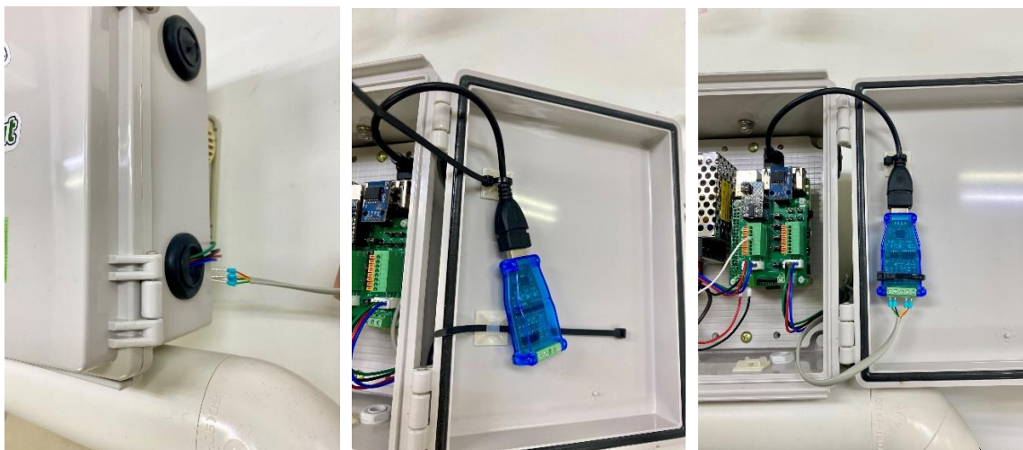
図 7：DIY キット内気象ノードへの取り付け例
