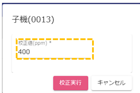
図 31：CO2 校正ダイアログ画面
