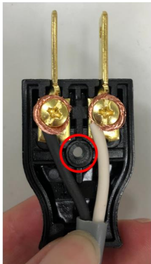
ネジ穴に配線がかからないようにする
