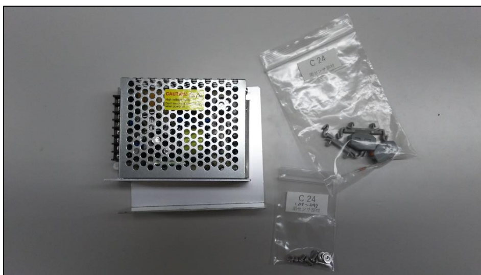
電源ユニット部分（組み立て前、表面）
