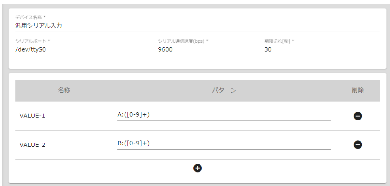
図 48：デバイス設定（汎用シリアル）画面
