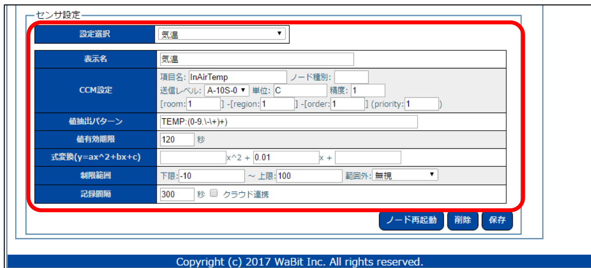
図 49 : 汎用シリアルセンサ設定画面(センサ詳細)
