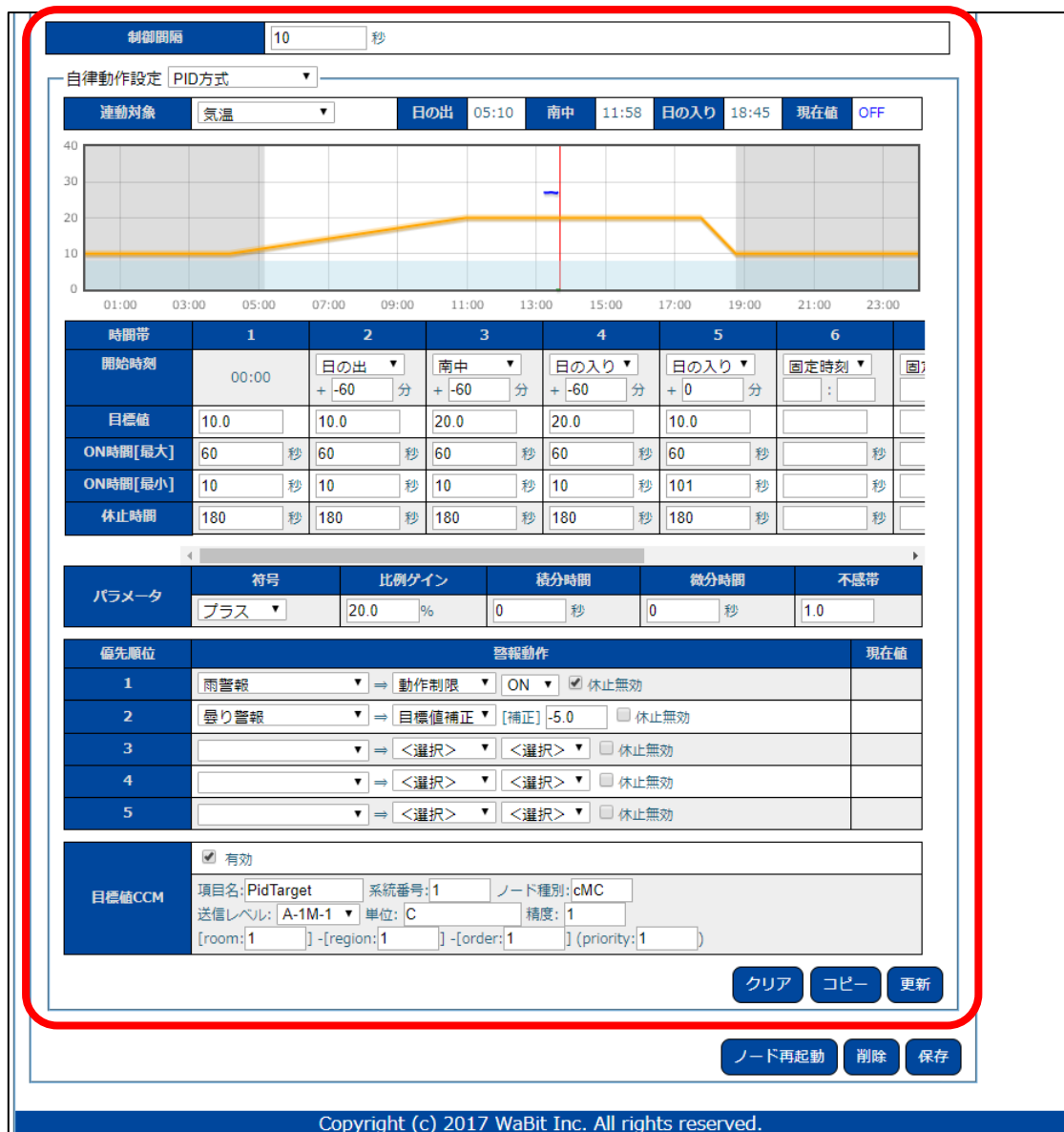
図 58 : アクチュエータ設定画面(自律動作[PID 方式])
