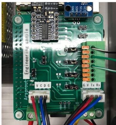
土壌水分センサの 黒白線と緑線と緑白線を差し込む
