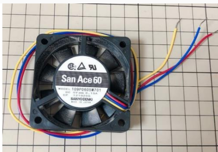
配線が赤線、青線、黄色線3本のファン
