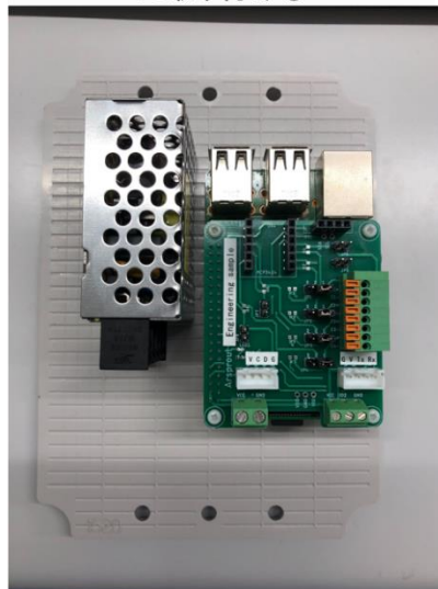
内気象ノード専用基板と電源に取り付ける
