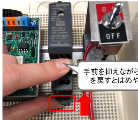
つまみを戻してDINレールに 固定する
