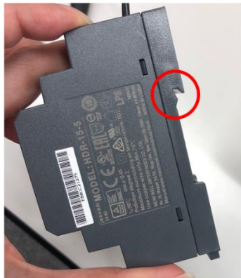
爪の部分をDINレールに 引っ掛けるようにセット
