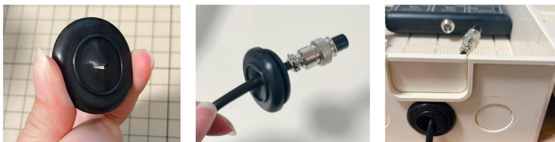
水質センサモニタと接続します。凸凹が合うように、線を差し込み、ねじを留めします。
