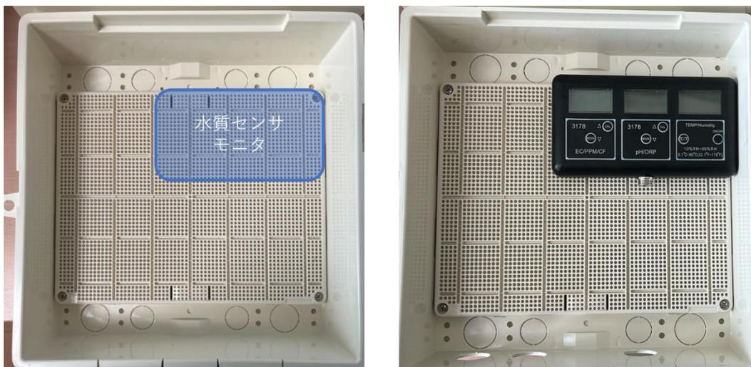
貼り付け後、水質センサ（モニタ部）の取り外しができることを確認してください。
