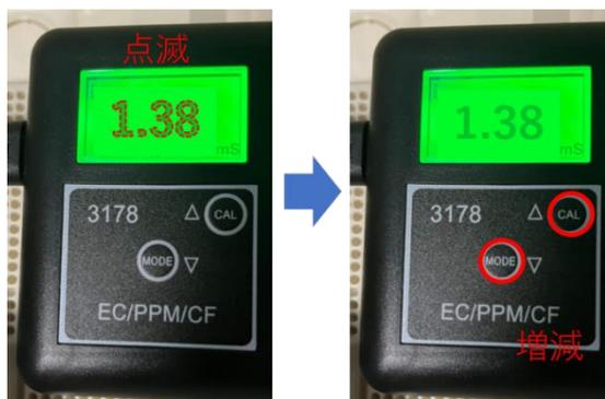
1.41 に調整完了後、ボタンから手を放します。値（1.41）が 3 回点灯し、EC の校正が完了します。
