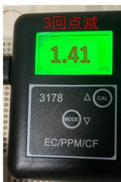
水質センサを校正液から取り出し、洗浄後、先端を拭きます。保管する場合は、必ず保護キャップとりつけて保管してください。（pH 計測の電極部の液が揮発し故障の原因となります。）
