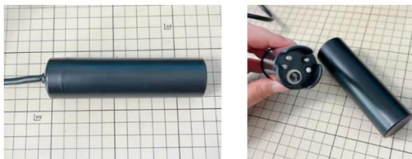
ビニールチューブ(WQ2)は、水質センサの先端保護用です。**養液につける際、任意で取り付け**てください。水流が弱い環境でチューブを取り付けて計測した場合、チューブ内に養液が滞留して正確な値が計測できない可能性があります。そのような場合は、チューブを外す、あるいはチューブ側面に穴を開けるなどの加工を行ってください。
