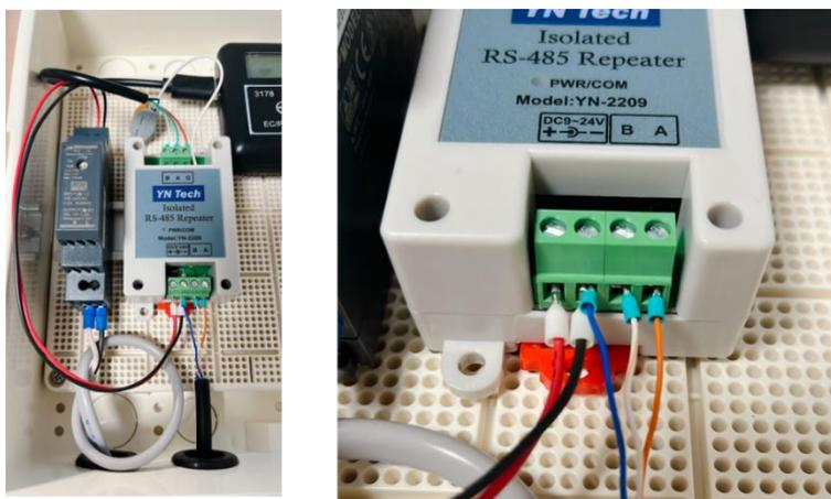
抵抗(WQ2)を U 字型に曲げて 1 センチ程度にカットし、RS485 中継器の A と B へ抵抗を接続します。
