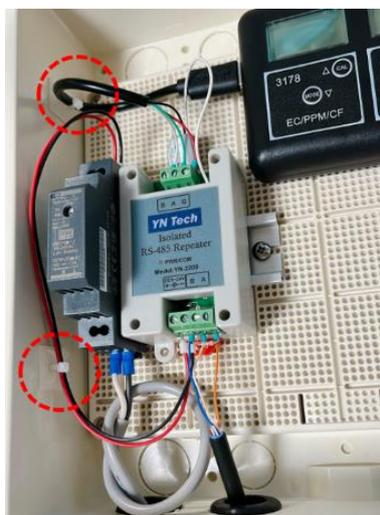
RS485 通信ケーブルの端をグロメットを通して、内気象ノードまたは制御ノードのボックス内へ入れます。
