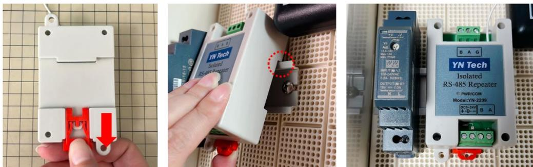
スイッチング電源と RS485 中継器が DIN レールに**しっかり固定されていることを確認**してください。
