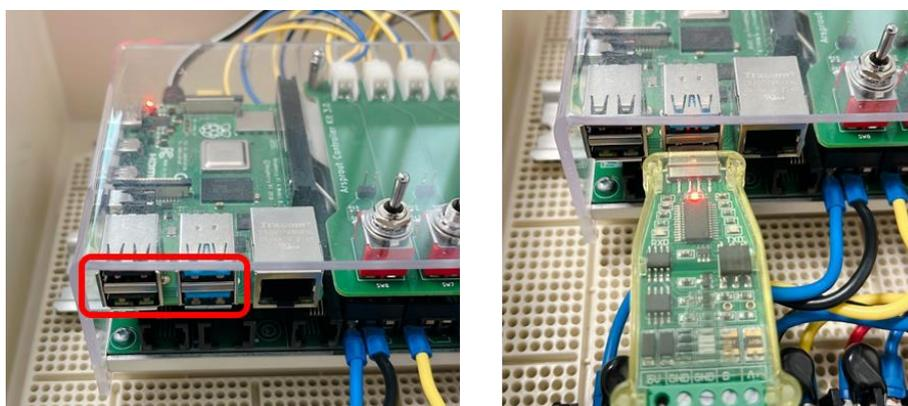
内気象ノードの場合は、USB-RS485 通信アダプタに USB 延長ケーブルを取り付け、RaspberryPi の USB へ接続します。
